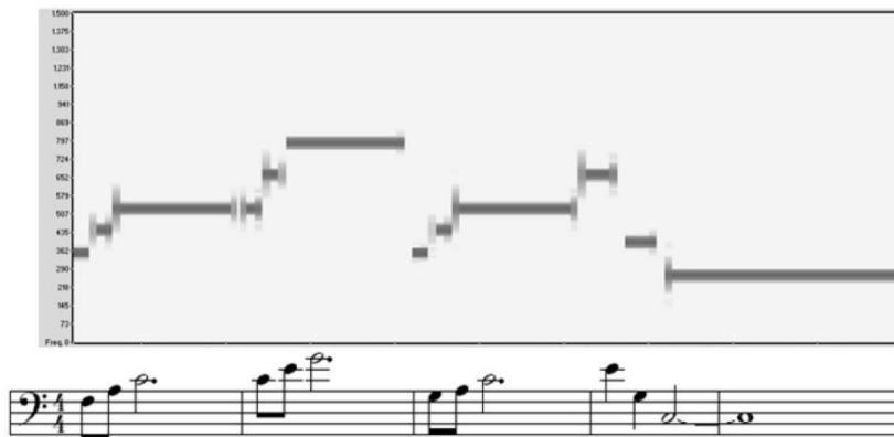
Figura 2.13. El espectrograma de una melodía sintetizada mediante ondas sinusoidales revela información musical sobre las notas que la componen (Iñesta, 2013).
