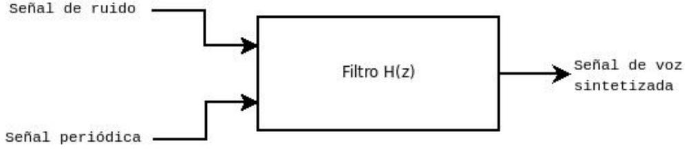
Figura F.1: Representación del esquema de modelado de voz según el método LPC
