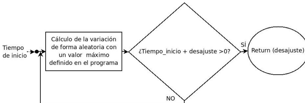
Figura 4.9: Diagrama de bloques de la función de creación del desajuste temporal.
