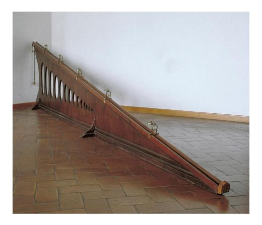
Fig. 7. Recreación del dispositivo experimental de Galileo Galilei para experimentos de la ley de la caída de los cuerpos, imagen extraída del Museo científico de Florencia. Se puede observar el plano inclinado por el que cae la bola y las campanas situadas sobre éste.
