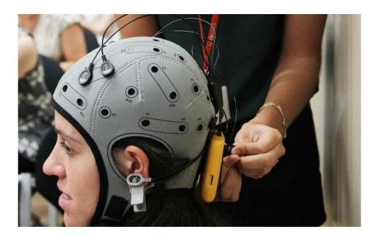
Fig.109. A través del casco, que se llama Enobio y se conecta con el organismo mediante electrodos, los científicos miden la actividad cerebral y cardíaca del paciente. Los sensores calculan las emociones a partir de los patrones cerebrales, cardíacos, musculares y de acelerometría que se generan en el organismo ante un determinado sentimiento. Imagen obtenida de "elpais.com".
