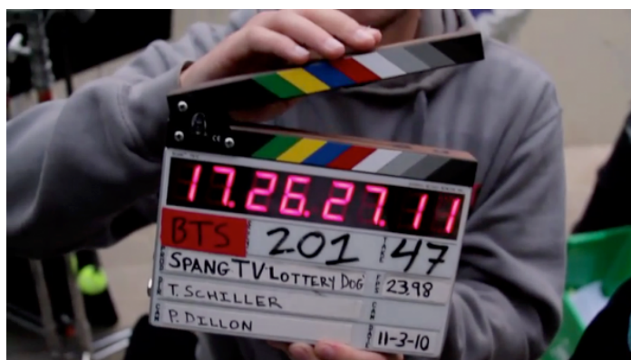
Figura 4.15: Claqueta cinematográfica. Modelo con sincronización por código SMPTE
