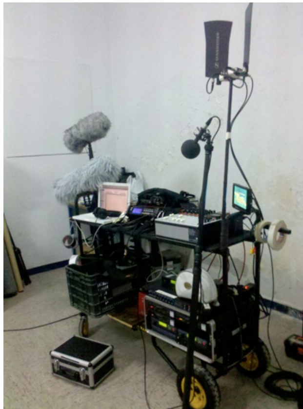
Figura 4.3: Equipo de grabación de sonido directo, instalado sobre carro portátil para facilitar el desplazamiento entre planos, secuencias y sets
