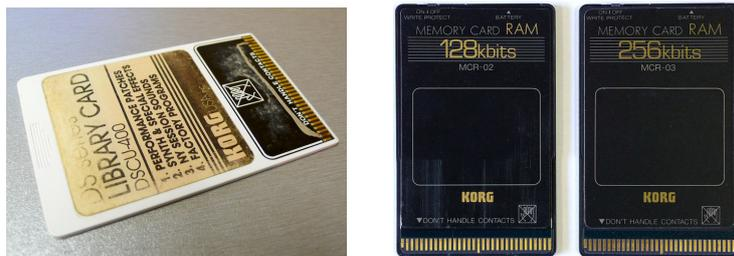
Figura 1.15: Memorias extraíbles del *Korg DS-8*. Memoria ROM *DSCU-400* (izqda) y dos versiones de memoria RAM: *MCR-02* y *MCR-03* (dcha).
