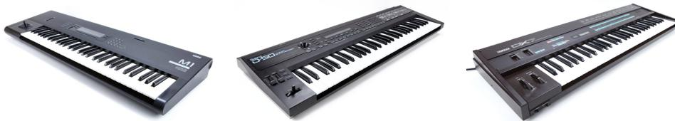
Figura 1.23: Sintetizadores digitales más vendidos de la historia (de izda a dcha): *Korg M1*, *Roland D-50* y *Yamaha DX7*. El *Korg M1* combina síntesis sustractiva y por muestreo, el *Roland D-50* está basado en síntesis aritmética lineal y el *Yamaha DX7* utiliza síntesis FM.
